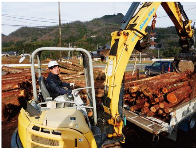
グラップルによる材の積み込み作業
