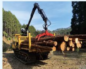
フォワードへ木材の積み込み作業
